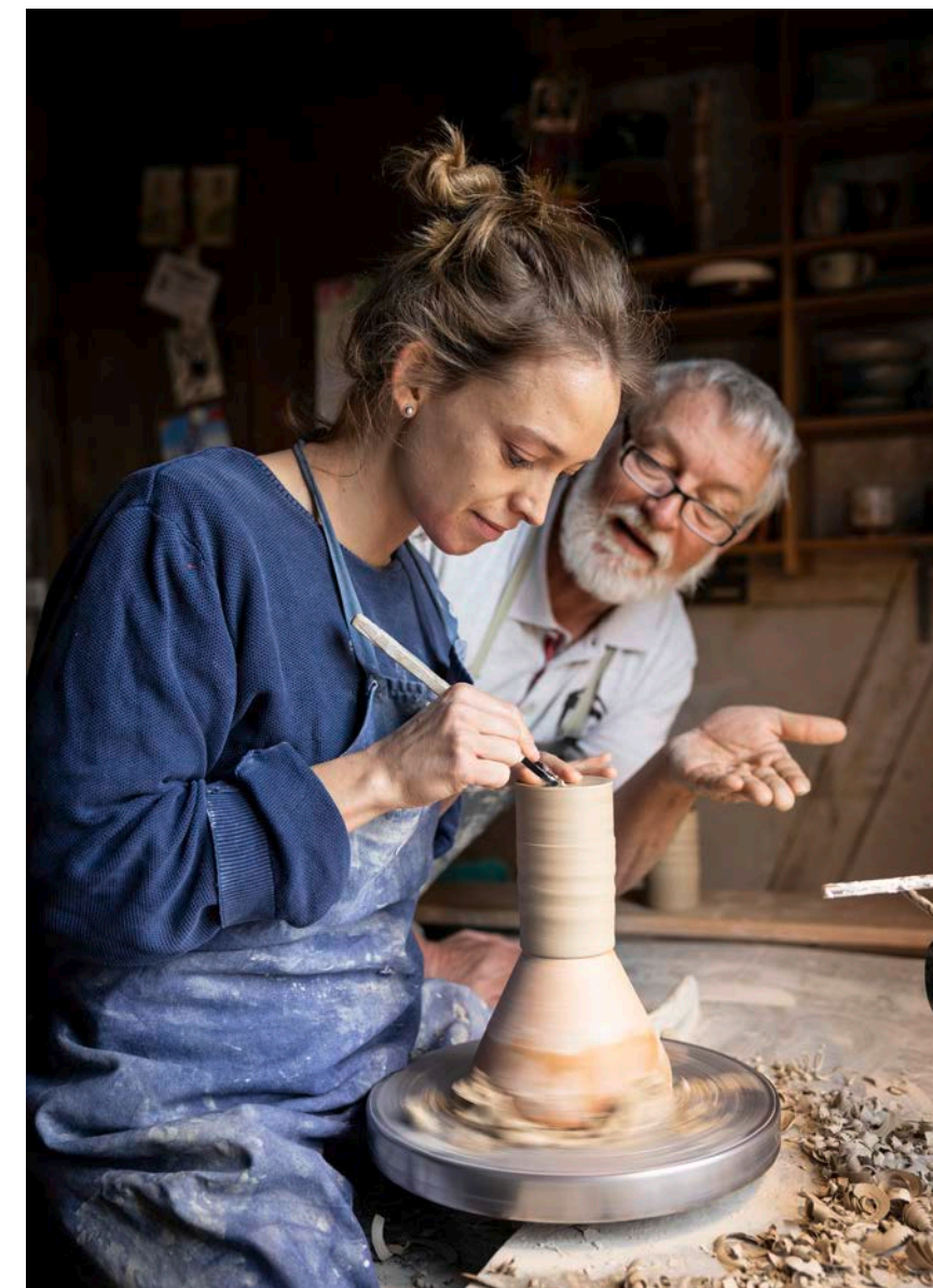
Ohne Zittern und Zagen: Eduard Kohler schaut seiner Tochter Helen beim sogenannten Abdrehen über die Schulter. Dabei trägt die Keramikerin mit einem Abdrehwerkzeug zum Ebnen den Ton vom Boden des angetrockneten – «lederharten» – Objekts ab. Sind alle Schritte gemacht, entsteht einer der Kohlerschen Partybecher (siehe Seite 70).
